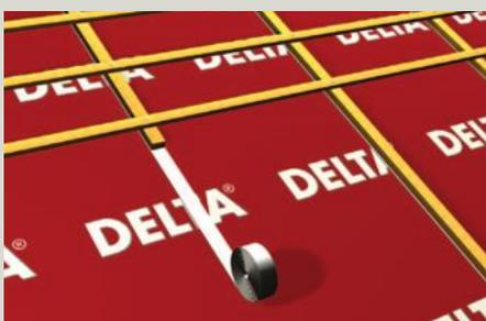
При устройстве гидроизоляции кровли помимо проклейки мест нахлёста плёнок необходимо использовать уплотнительную ленту DELTA®-SCHAUM-BAND SB 60 под контробрешётку для предотвращения затекания воды в конструкцию крыши через гвоздевое соединение. Проходки вентиляционных и канализационных вытяжек, антенных выводов через гидроизоляционные плёнки выполняются при помощи соединительных лент DELTA®-FLEXX-BAND, DELTA®-MULTI-BAND или специальных уплотнительных манжет.
