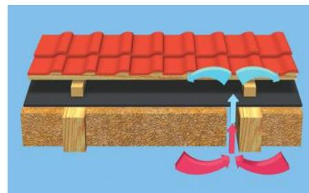
**конвективный поток** через неплотные (воздухопроницаемые)стыки в конструкции крыши
