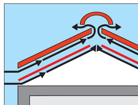
**Сегодня:** мансарда с полной теплоизоляцией стропил и одной зоной вентиляции (одним вентиляционным зазором). Диффузионная гидроизоляция (ветрозащита) и пароизоляционный слой.
