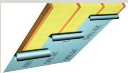
При монтаже пароизоляционных плёнок DELTA® необходимо соблюдать общие правила устройства пароизоляционного слоя утеплённой конструкции скатной крыши. При выборе марки плёнки необходимо принимать во внимание технические характеристики данного материала (прочность на разрыв, паропроницаемость) и температурно-влажностный режим внутренних помещений. Маркированная сторона плёнки должна быть обращена внутрь помещения.
