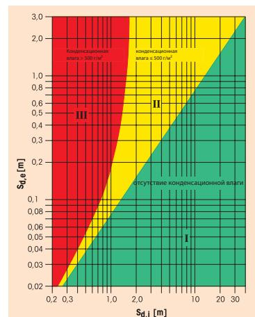
Зона диффузионных гидроизоляционных пленок с высокой паропроницаемостью
