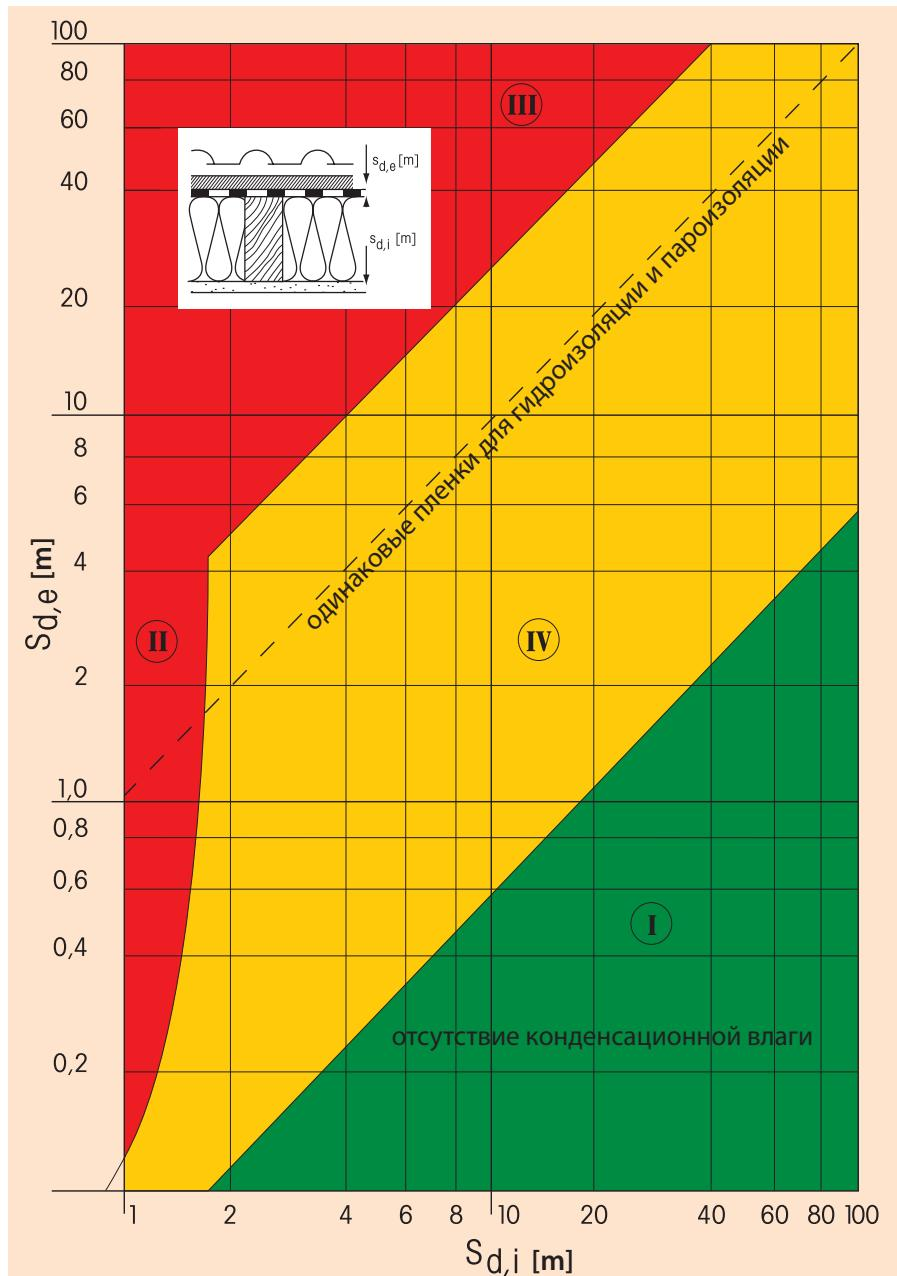
Возможность образования конденсационной влаги в крышах с однослоевой вентиляцией в соответствии с расчётными допущениями DIN 4108, часть 3 при различной эквивалентной толщине диффузии гидроизоляционного слоя  $S_{de}$  и внутреннего конструктивного слоя крыши  $S_{di}$
