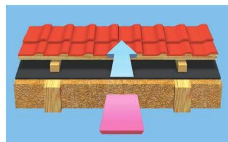
**и диффузия** водяного пара, обусловленная перепадом наружной и внутренней температуры и градиентом давления пара.
