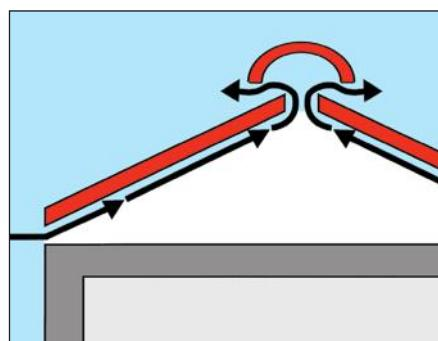
**Сегодня:** утеплённая мансарда с двумя зонами вентиляции (двумя вентиляционными зазорами), с гидроизоляционным и пароизоляционным слоями.
