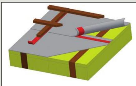
Поверх теплоизоляции стабильной формы
