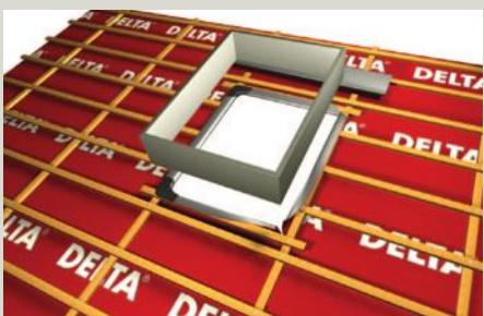
Для создания воздухо- и водонепроницаемого примыкания гидроизоляционной диффузионной мембранны к мансардному окну используются соединительные ленты DELTA®-FLEXX-BAND и DELTA®-MULTI-BAND. Допускается применение клея DELTA®-THAN для герметизации проёма окна. Примыкание диффузионной мембранны к окну должно быть водо- и воздухонепроницаемым.
