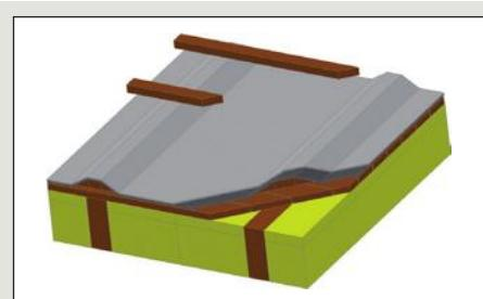
Крыши с двухслойной вентиляцией, укладка гидроизоляции поверх настила и контробрешётки
